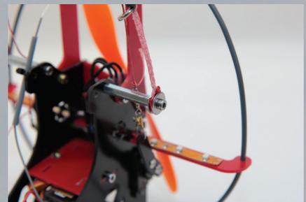
Les élévateurs sont fixés sur des entretoises en aluminium, simplement à l'aide d'une vis.
