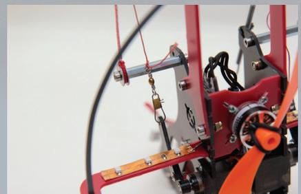
Des leds peuvent être positionnées sur le hauban horizontal. On remarque les émerillons installés par l'auteur sur les commandes de frein, plus pratique pour un démontage sans modification de réglage.
